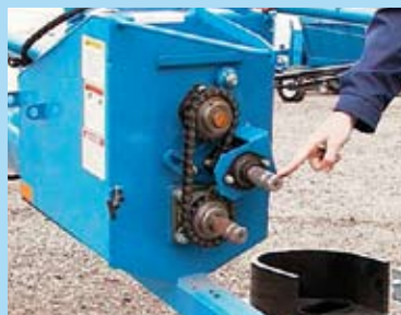
Système d'inversion pour nettoyage série XL.
