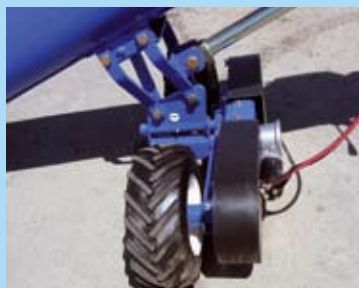
Système de déplacement de la trémie hydraulique.
