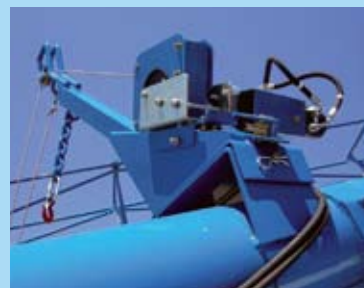
Levage hydraulique de la trémie.
