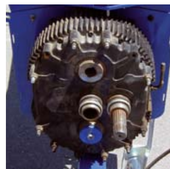
Réducteur série HP avec inversion du sens de rotation intégré.
