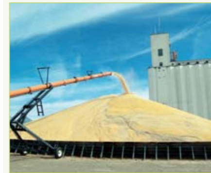
Chargement par manutention mobile, vis sur chariot ou convoyeur à bande.
