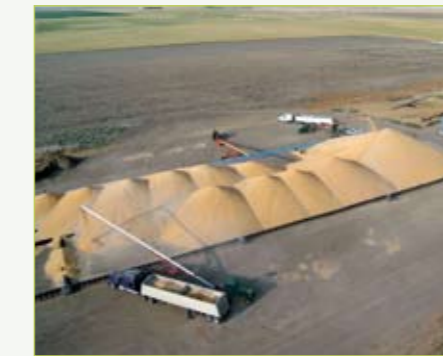
Chargement par manutention mobile, vis sur chariot ou convoyeur à bande.
