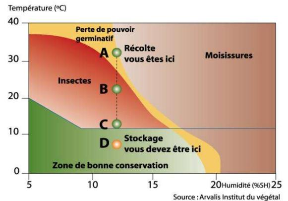
Pour atteindre ces objectifs de température, la masse de grain doit être traversée par un air de 7 à 10°C inférieur à celui du grain.
