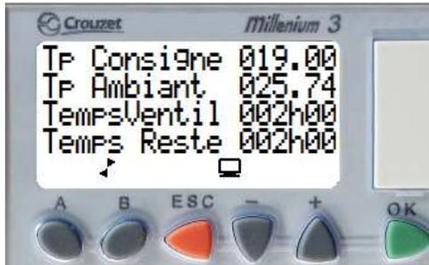
Sur l'écran principal figure les indications suivantes : la température extérieure, la température de consigne pour le déclenchement de la ventilation, le temps de ventilation désiré et le temps de ventilation restant.
