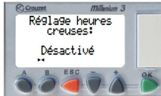
Lorsque vous êtes sur l'écran « Réglage heures creuses », un appui sur le bouton **OK** vous permet d'accéder aux 4 écrans disponibles afin de modifier les heures de début et de fin des heures creuses.
